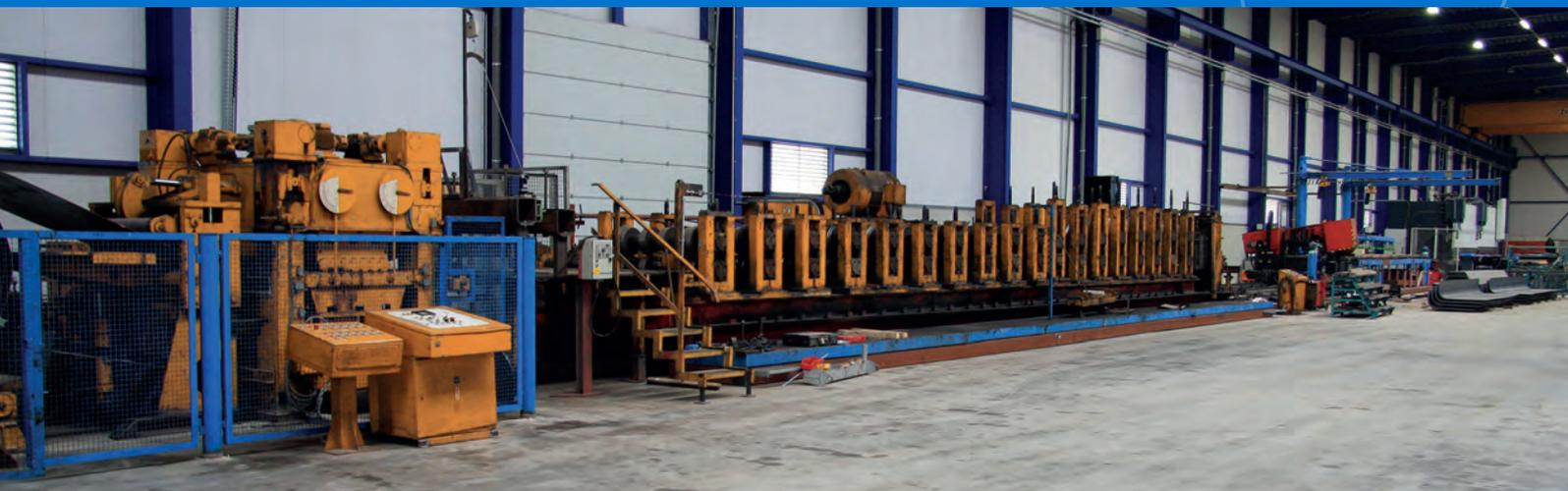
Come produttore e fornitore di servizi per l'edilizia ci attiviamo per realizzare profili "su misura" per i cantieri e convenienti economicamente, che si caratterizzano per un'ottima sagoma, precise tolleranze dimensionali e aumento della resistenza nei punti di piegatura attraverso la formatura a freddo. Le nostre soluzioni su misura per ogni cantiere e la puntualità delle consegne serviranno per una fornitura senza intoppi per il Vostro prossimo fabbisogno.
